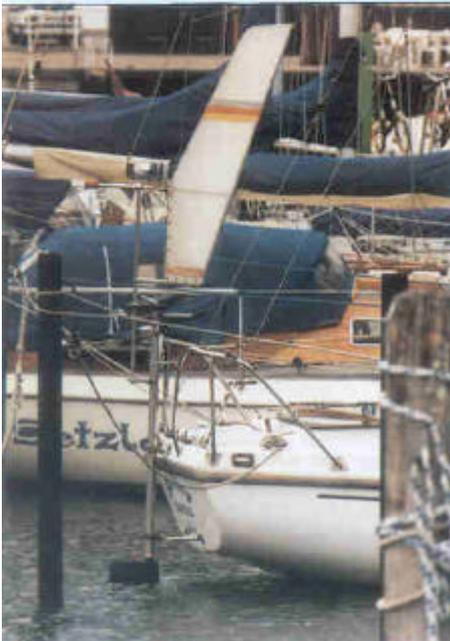
Este sistema de timón auxiliar Windpilot es apto para barcos de hasta 11m / 36 pies de eslora.
