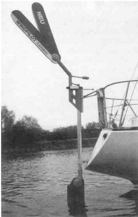
Sistema de timón auxiliar Windpilot Caribic, 1988
