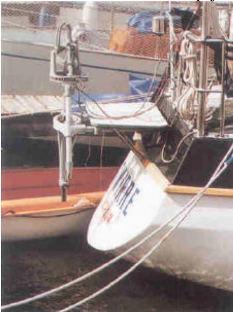
Los sistemas de timón oscilante con un brazo oscilante vertical pueden requerir bridas de montaje ampliadas en los modernos espejos de popa con inclinación hacia delante.
