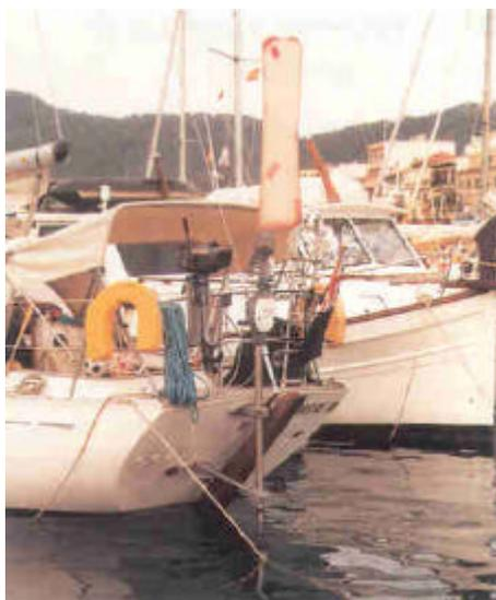
Montaje en un lado junto a un timón auxiliar. La distancia mínima respecto del timón principal es de 30 cm/12 pulgadas
