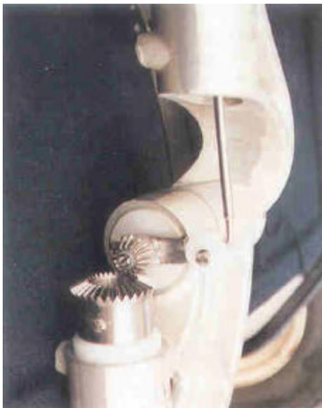
Conexión del engranaje cónico de 360 grados de Windpilot Pacific 360 con una relación 2:1
