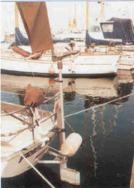
Un sistema de timón auxiliar con aleta V de RVG con sistema de aleta de centrado colocado en el barco Sy de fibra de vidrio, que tiene una eslora de 10 m / 33 pies, anclado en Palma de Mallorca
