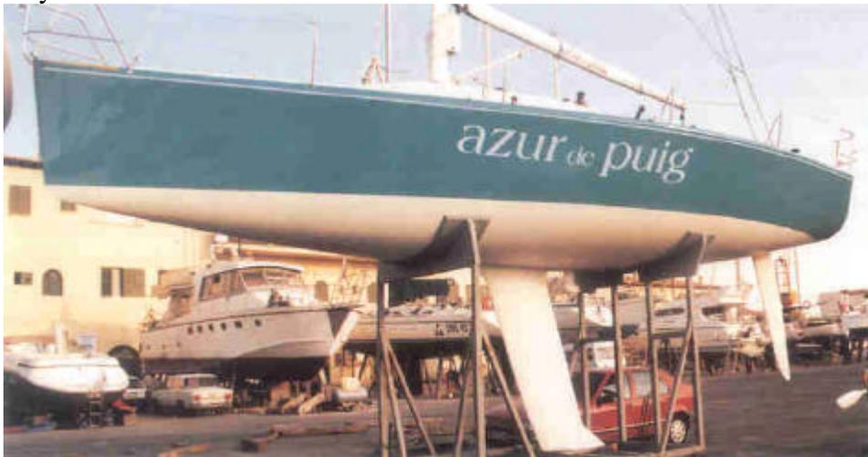
Las líneas del casco de un yate moderno con un timón compensado: rápido, pero no particularmente confortable
