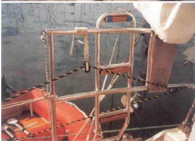
Los cabos de gobierno pueden tensarse fácilmente usando un motón adicional.
