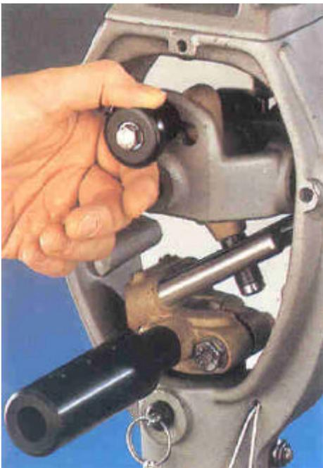
La conexión Hydrovane tiene un engranaje reductor para conseguir una mejor amortiguación.
