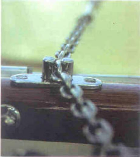
Guarnición de la caña del timón y eslabón de la cadena, Windpilot Pacific
