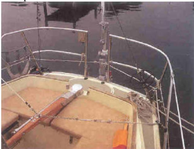
Recorrido de transmisión corto hasta la caña del timón con el Windpilot Pacific. Los cabos de gobierno comienzan a nivel de la cubierta.
