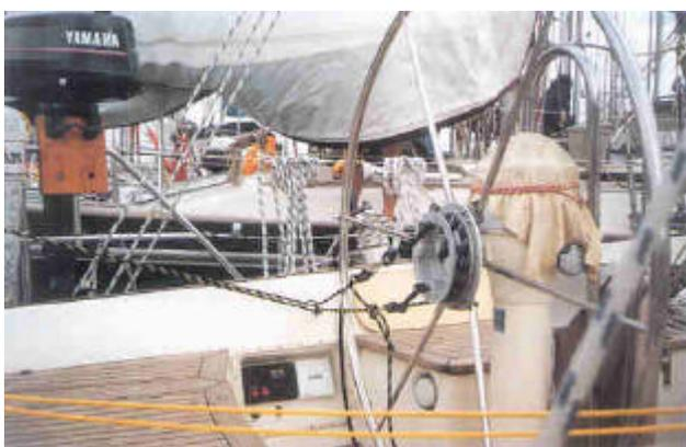
Tendido de los cabos de gobierno sobre un lado, punto de conexión con grilletes.
