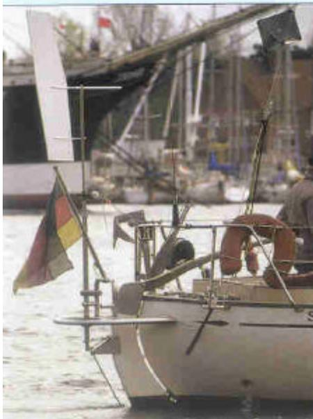
Sistema de aleta de centrado con aleta V en el timón principal construido a medida para un barco de 10 m / 32 pies diseñado por Olle Enderlein.
