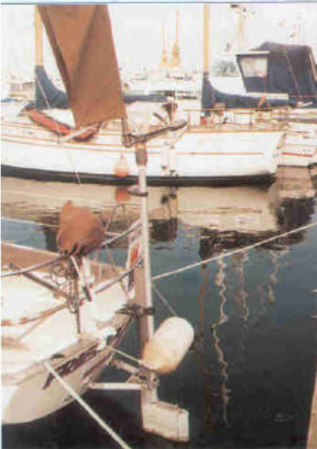
Een RVG V-vaan hulproersysteem met trimvlak op een polyester zeiljacht van 10 meter in Palma de Mallorca
