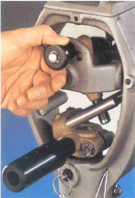
De overbrenging van de Hydrovane kan in drie standen worden gezet om betere demping te verkrijgen
