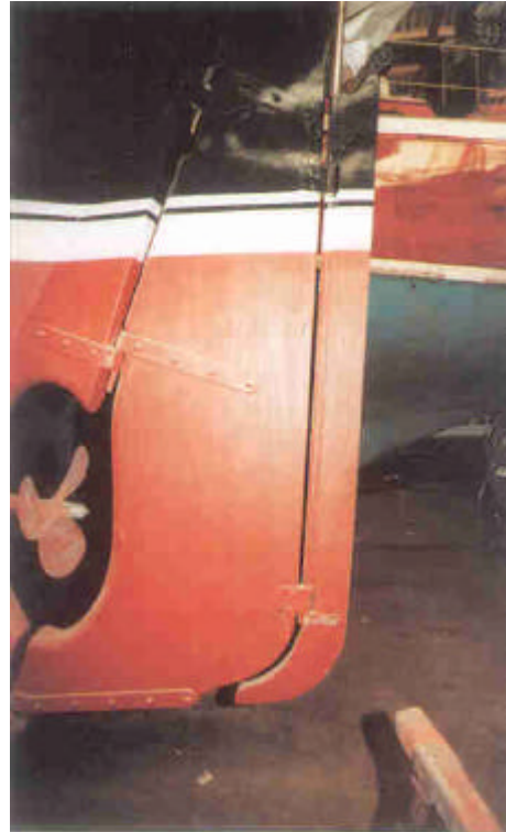
De verhouding trimvlak-hoofdruer: dit systeem bemoeilijkt het achteruitvaren op de motor.
