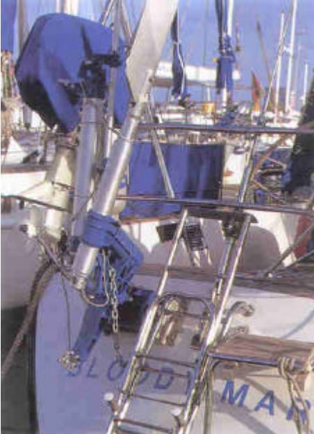
Een excentrisch geplaatste servo-pendulumvaan zal niet goed functioneren
