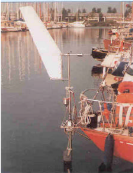
Dit Windpilot Pacific V-vaan systeem MK I (1969) is van roestvrijstaal gemaakt.
