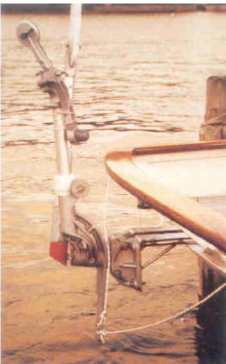
Deze bevestiging van een Windpilot Pacific op een gaffelkotter van 25 ton heeft al 12 jaar prima gewerkt.
