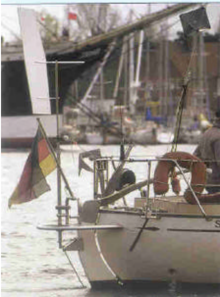
Een systeem met V-vaan en trimvlak op het hoofdruer, op maat gemaakt voor een Olle Enderlein van 10m.
