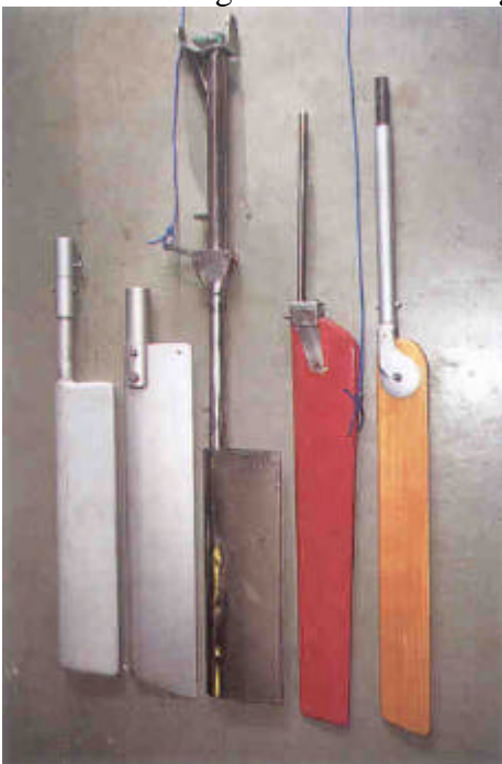
Bescherming tegen overbelasting (van links naar rechts): Aries, Sailomat. Monitor, Windpilot Pacific (oud), Windpilot (nieuw).
