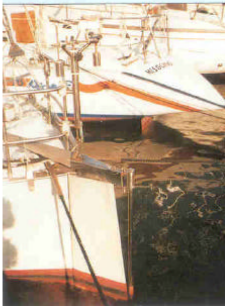
Een systeem met H-vaan en trimvlak op het hoofdruer. Een op maat gebouwde Windpilot Pacific voor een Deense Kaskelot.
