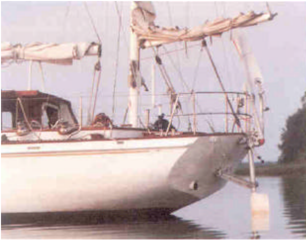
Een bezaan die over de spiegel steekt, is problematisch voor een windvaan
