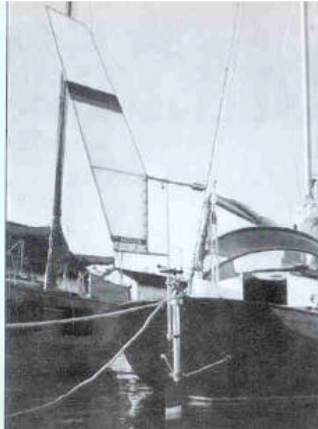
V-vaan, Windpilot Atlantik hulproersysteem
