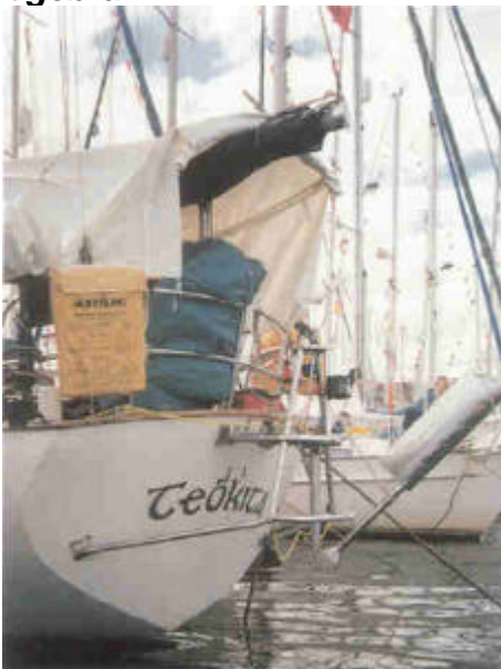
Roerblad buiten gebruik, Monitor.
