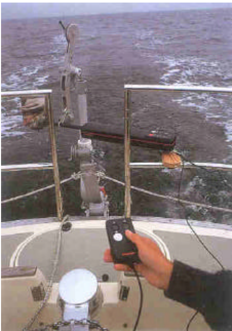
Synthese van stuurautomaat en windvaanbesturing met afstandsbediening: ideaal voor zeilen met een kleine bemanning
