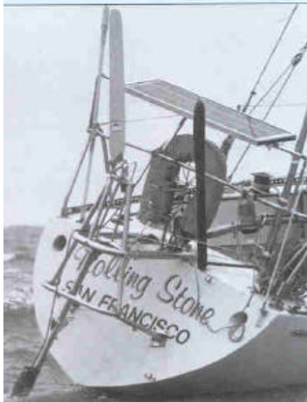
Het traditionele Monitor servo-pendulumsysteem met H-vaan.
